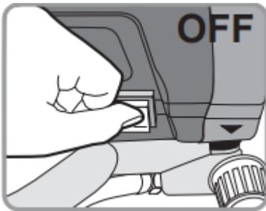
**7.** El rociador comenzara a bombear y el agua o el solvente de lavado, así como las burbujas de aire serán purgados del sistema. Deje que se descarguen los fluidos en la cubeta, de a 30 a 60 segundos y luego apague la unidad.
