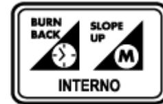
**BURN BACK:** luego de la señal de detención de la soldadura, mantiene conectada la potencia y de esta forma regula la longitud del alambre para un nuevo comienzo.
